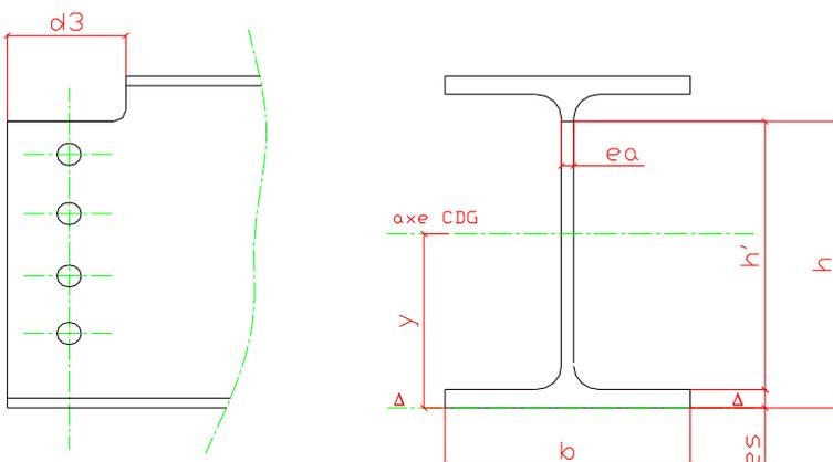
**vérification de la section au droit des boulons :**
