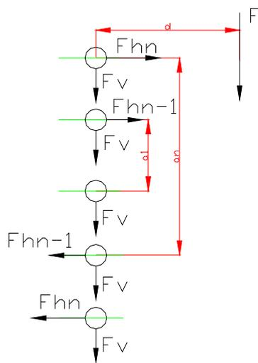
lorsqu'une file de boulons a à reprendre un effort  $F$  situé à une distance  $d$ , les boulons sont soumis à deux forces de cisaillement :
